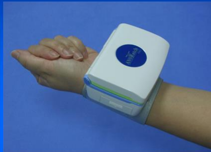
心電圖機, 血壓機, 與脈診儀的微小化綜合體
